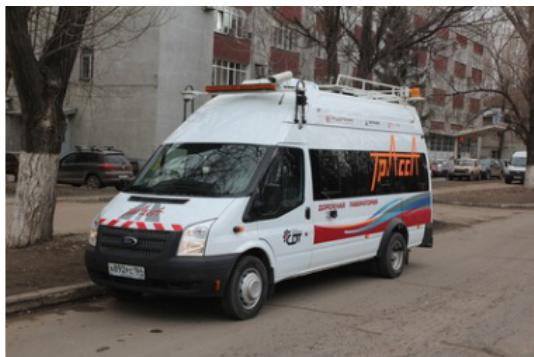
Рисунок 1 – Передвижная комплексная дорожная лаборатория КП 514 СМП «Трасса»
