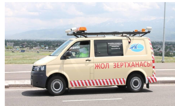
Рисунок 2 – Комплекс измерительного оборудования по видеопаспортизации автомобильных дорог НПО «Регион»
