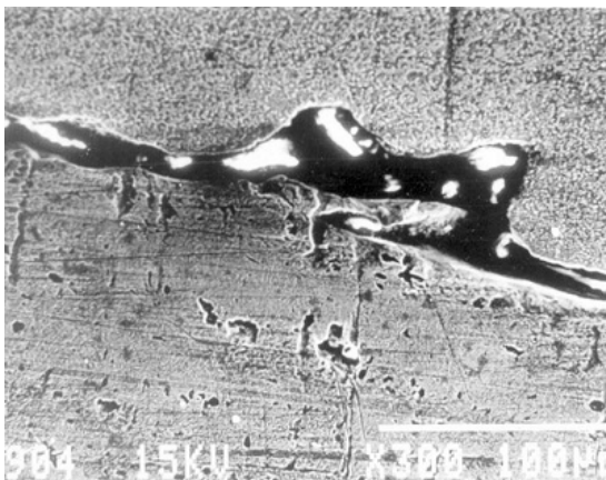
Рисунок 1 – Растровая микроэлектронная фотография шлифа вертикального среза стального образца (нижняя область) с композиционным покрытием Ti-TiC (верхняя область)
